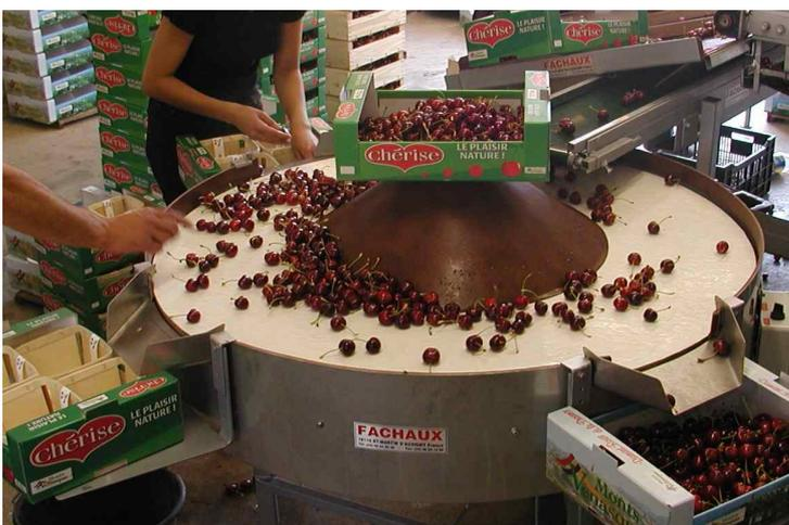
*Rotary (table tournante) diamètre 1,2m*
