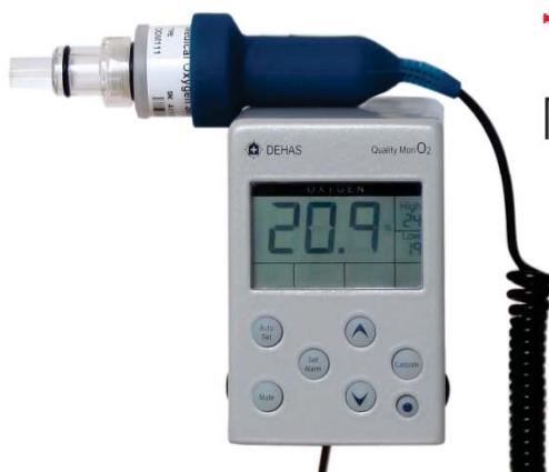
Das QualityMon O<sub>2</sub>-Sauerstoffmessgerät dient zur Bestimmung und Überwachung der Sauerstoffkonzentration in Atemgasmischungen in medizinischen Anwendungen. Das Quality MonO<sub>2</sub> kann für die Funktionsüberwachung der Atemgasgemische von Anästhesiegeräten und Atemschutzgeräten, sowie Säuglingsinkubatoren verwendet werden.
